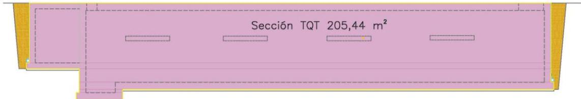
$$205,44 \text{ m}^2 (\text{Sección Tanque}) \times 8,40 \text{ m} (\text{Ancho Tanque}) = 1725,70 \text{ m}^3$$
